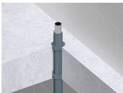
Metalen buizen voorzien van Armaflex isolatie
