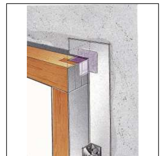
De butylhoek zorgt voor een lucht- en waterdichte hoek. Bitumenband goed aandrukken met een harde nadenroller.
