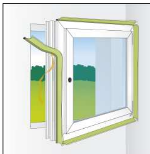
Bevestiging van de zelfklevende lijmverbinding van TP001 illmod i aan het kozijn
