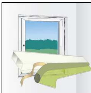
Bevestiging van de zelfklevende lijmverbinding van TP001 illmod i aan de kamerlijst.
