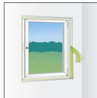
Na bevestiging van de kamerlijst aan het kozijn activering van TP001 illmod i door de uit stekende folie af te scheuren.
